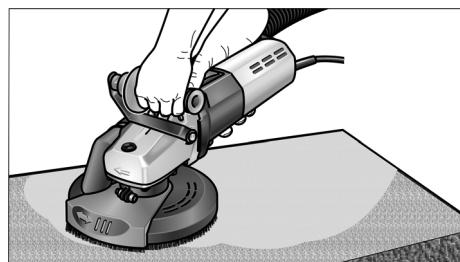
7. Forhøy trykket slik at slipetallerkenen får kontakt med arbeidsflaten. Sving herved saneringssliperen med overlappende bevegelser.
