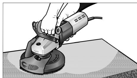
7. Den Druck erhöhen, um den Schleifteller mit der Arbeitsfläche in Kontakt zu bringen. Dabei den Sanierungsschleifer mit überlappenden Bewegungen schwenken.
