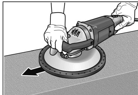
7. Hausssez la pression d'applique pour amener le plateau de ponçage en contact avec la surface de travail. Imprimez ce faisant, à la ponceuse de rénovation, des mouvements circulaires se chevauchant.
