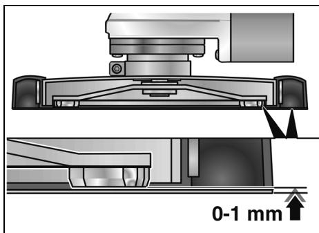
O anel de borracha para aspiração deve sobressair ca. 0-1 mm sobre o prato de lixar. Em caso de necessidade, corrigir (ver «Ajustar o resguardo de protecção»).
