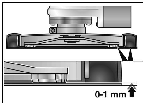
Gumijas nosūcējgredzenam jābūt izvirzītam apm. par 0–1 mm vīrs slīpēšanas šķīvja. Ja nepieciešams, labojet (sk. „Nostādiet aizsargapvalku“).
