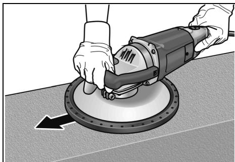
7. Forhøy trykket slik at slipetallerkenen får kontakt med arbeidsflaten. Sving herved saneringssliperen med overlappende bevegelser.
