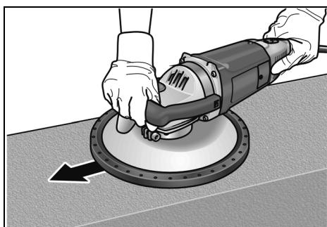
7. Den Druck erhöhen, um den Schleifteller mit der Arbeitsfläche in Kontakt zu bringen. Dabei den Sanierungsschleifer mit überlappenden Bewegungen schwenken.
