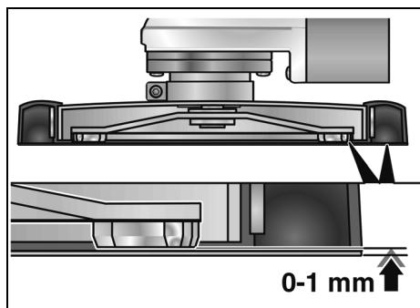
Kumisen imurenkaan tulee ulottua noin 0–1 mm hiomalaikan ulkopuolelle. Korjaa tarvittaessa (katso »Suojuksen säätö«).
