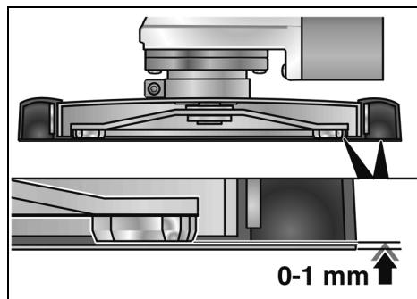
Gummi-udsugningsringen bør røre ca. 0-1 mm ud over slibtallerken. Korrigér om nødvendigt (se „Justering af beskyttelseskappe“).
