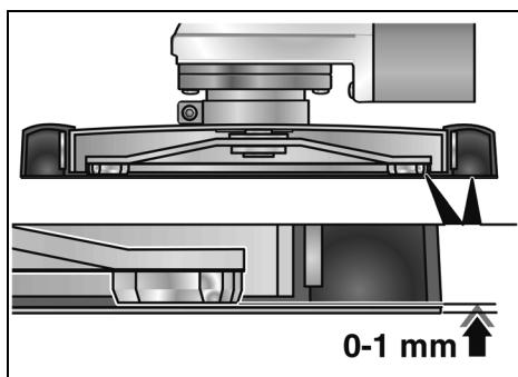
Il faudrait que la couronne d'aspiration en caoutchouc dépasse d'env. 0 à 1 mm au dessus du plateau de ponçage. Corrigez le réglage si nécessaire (voir « Déplacez le capot de protection »).
