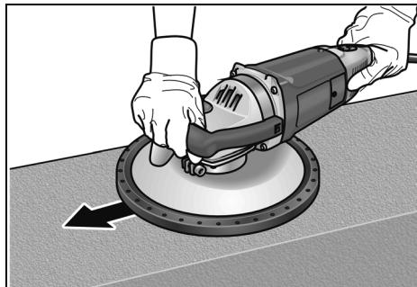
7. Verhoog de druk om de schuurschijf met het werkoppervlak in aanraking te brengen. Draai de renovatieschuurmachine daarom met overlappende bewegingen.
