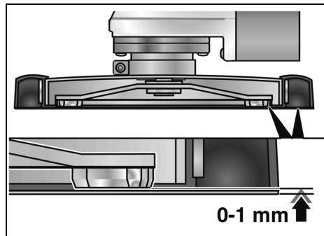
Der Gummi-Absaugring sollte ca. 0–1 mm über den Schleifteller hinausragen. Bei Bedarf korrigieren (siehe „Schutzhaut verstellen“).
