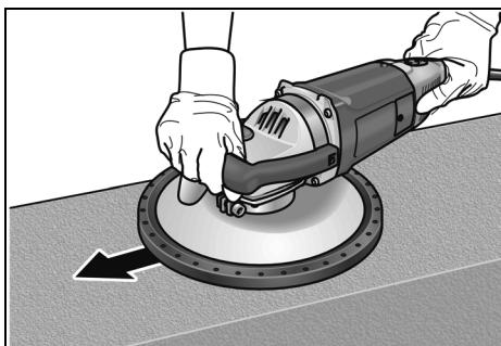
7. Aumentar la presión, a fin de que el plato amolador entre en contacto con la superficie a procesar. Mover la amoladora de saneamiento con movimientos solapados.
