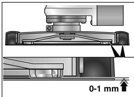
El anillo de aspiración de caucho debería sobresalir aprox. 0–1 mm del plato amolador. Corregir si hiciera falta (ver «Ajustar la cubierta»).
