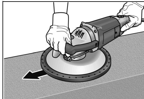
7. Нажмите сильнее, чтобы тарельчатый шлифовальный круг соприкасался с рабочей поверхностью. При этом шлифовальную машину для реконструкционных работ необходимо направлять движениями внахлестку.
